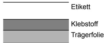
Etiketten bestehen wie in der Abbildung zu sehen aus drei verschiedenen Lagen. Der Klebstoff stellt für das Gerät das größte Risiko dar, denn er wird Druck und Wärme ausgesetzt. Die Trägerfolie trägt das Etikett beim Transport durch das Gerät. Die Kombination der verschiedenen Materialien kann Probleme verursachen.
